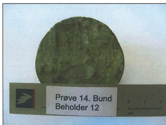
Overflade af beton; mørtellag er fjernet
